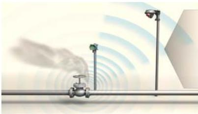
Gassonic ist ein kleines, sehr innovatives Unternehmen, welches für die Gaswarntechnik ein völlig neues Messprinzip kreiert hat. Grundidee war, den bei Gasleckagen in Hochdruckgasanlagen auftretenden Ultraschall zu detektieren. Diese Messung wurde unter dem Namen „Ultrasonic Gas Leak Detection“ sehr erfolgreich in den Markt eingeführt. Ultraschall ist nicht hörbar, kann aber sehr gut mit der Technik von Gassonic detektiert werden. Der unbestreitbare Vorteil dieses Messprinzips ist, dass kein
