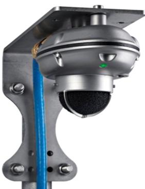
Die Ultrasonic-Detektoren wurden unter den Namen IS-5 und EX-5 bei MSA eingeführt. Die beiden Detektoren unterscheiden sich durch die EX-Schutzart. Der IS-5 ist eigensicher und der EX-5 ist druckfest gekapselt. Der EX-5 ist zusätzlich mit einem internen Selbsttest und einem Display ausgestattet.
